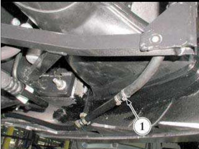
● 分离挡风玻璃清洗器管(1)并塞住泵出口，以防清洗液排放。
